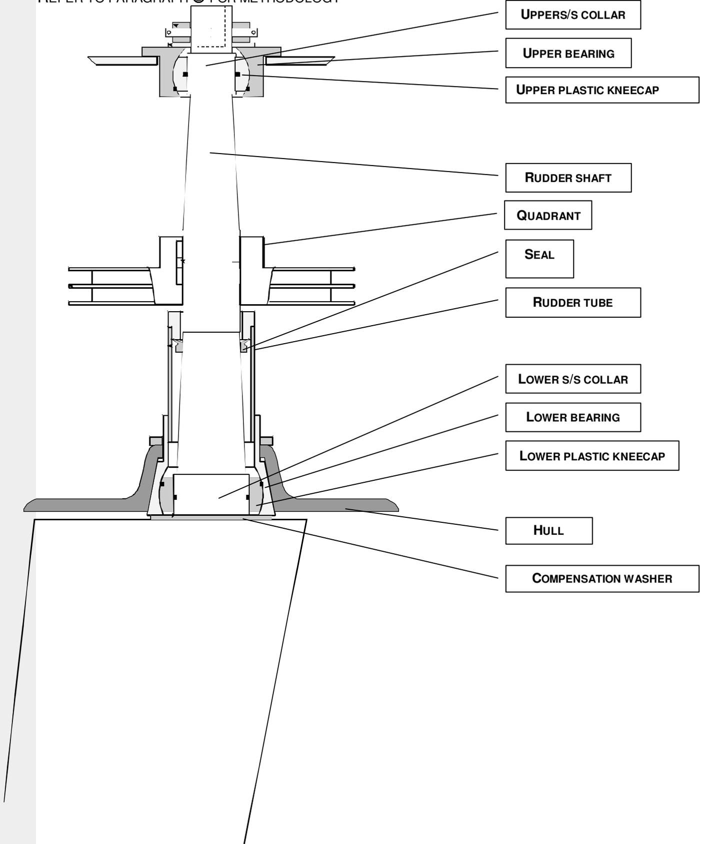
**④ RUDDER SYSTEM FOR ANTARES MOTOR BOAT**
