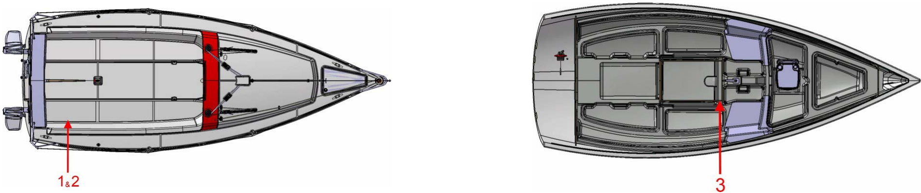
SCHÉMA D'IMPLANTATION - POMPES DE CALE
